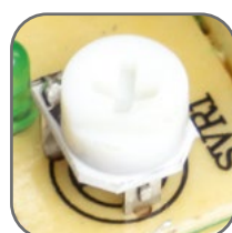
Возможность корректировки выходного напряжения
