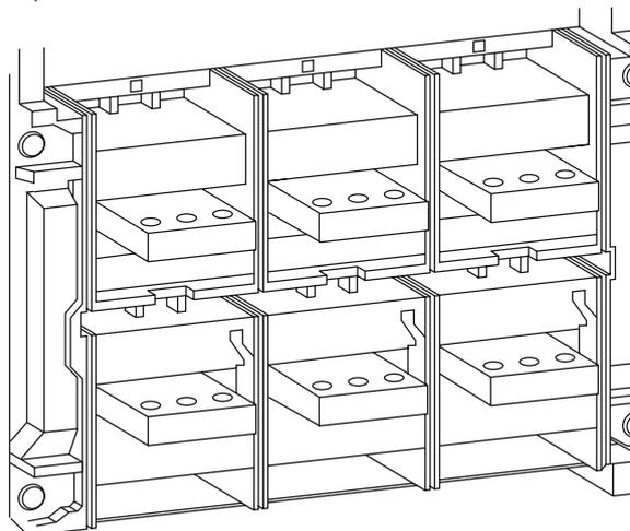
Выходы выключателя расположены сзади, шины при подключении к выключателю должны располагаться горизонтально.
