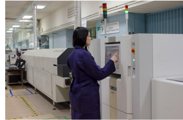
Контроль качества монтажа на установках АОИ Omron, Morantz
