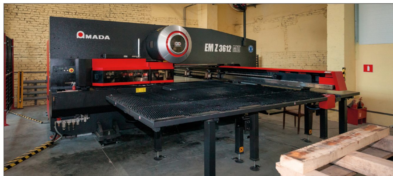
Высокоскоростной вырубной пресс Amada EMZ 3612MII для полноформатной обработки деталей.
